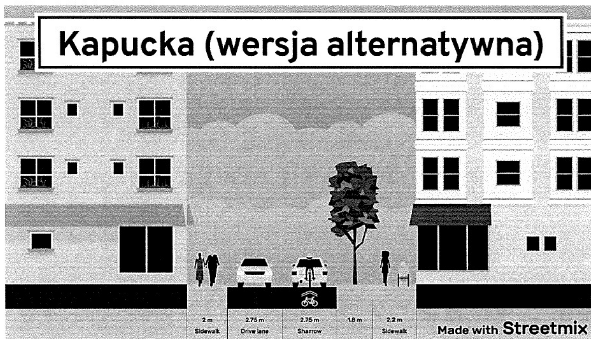
rys. 2 – Proponowany alternatywny przekrój ul. Kapuckiej (z oznakowaniem poziomym P-27 w pasie ruchu)
